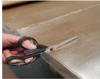
Einsetzen des Meldenetzes anstelle der Glimmer-Gleitschicht, einfaches Zuschneiden
